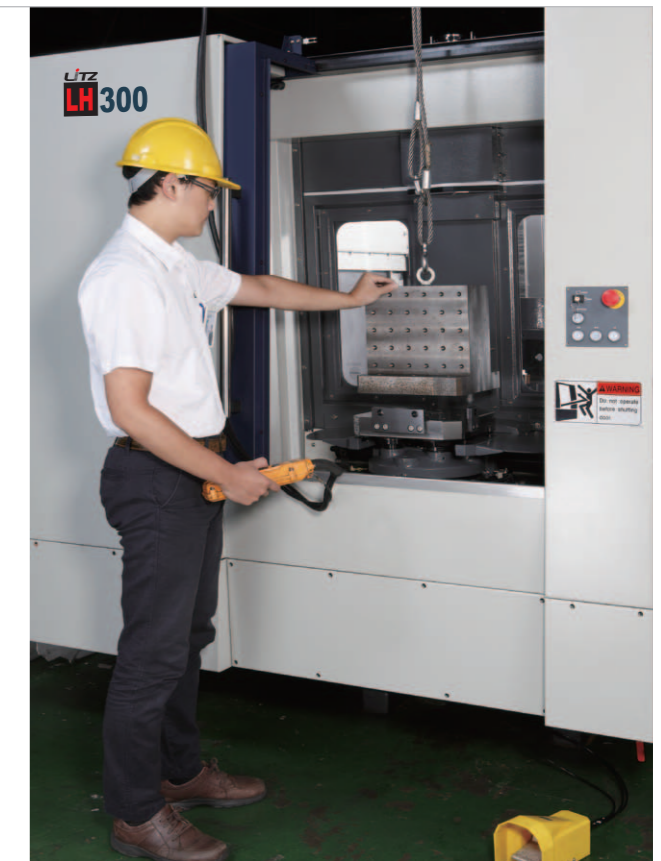
超大的門寬設計，方便零件或治具裝卸機台。
